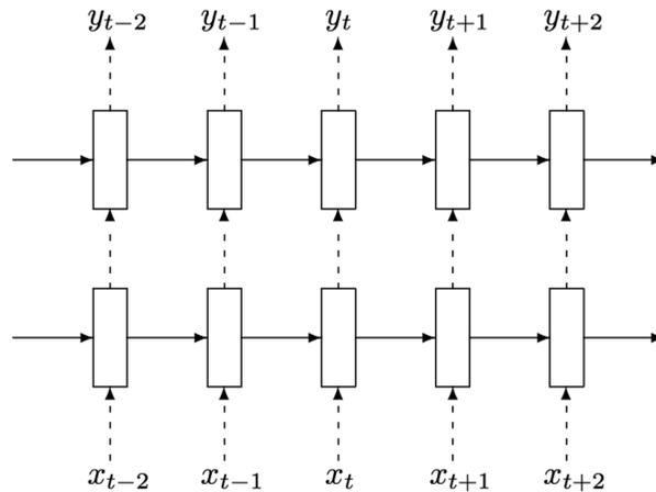
图 8-10 深层循环神经网络使用 dropout 示意图
