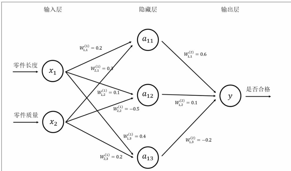
图 3-5 判断零件是否合格的三层神经网络结构图
