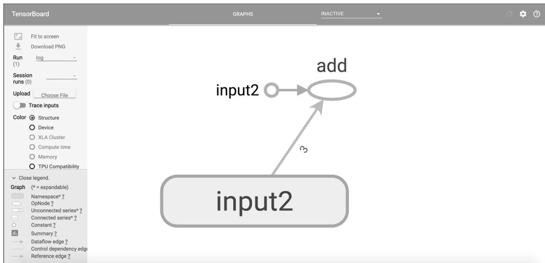
图 11-3 改进后向量加法程序 TensorFlow 计算图的可视化效果图
