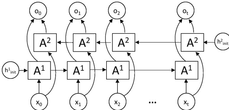
图 8-8 双向循环神经网络结构示意图
