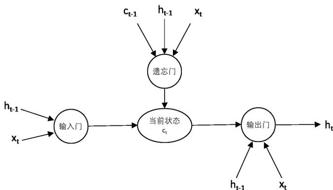
图 8-6 LSTM 单元结构示意图
