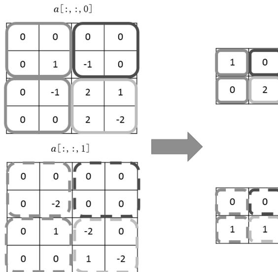
图 6-14 3×3×2 节点矩阵经过全 0 填充<sup>③</sup>且步长为 2 的最大池化层前向传播过程示意图
