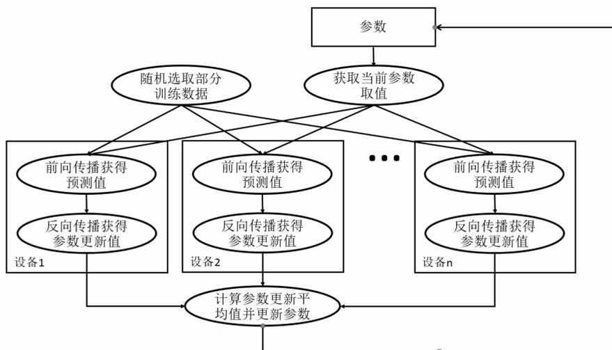
图 12-4 同步模式深度学习模型训练流程图
