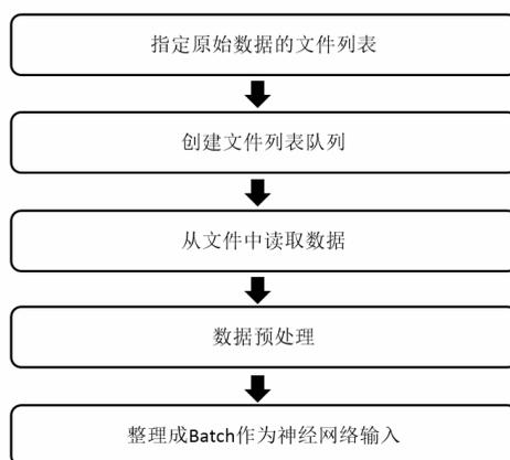
图 7-14 经典输入数据处理流程图
