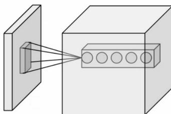
图 6-8 卷积层过滤器 (filter) 结构示意图<sup>①</sup>
