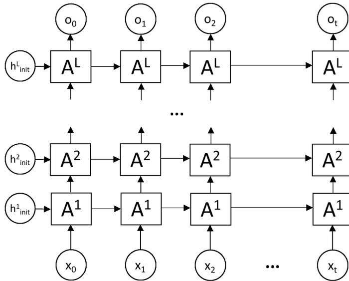
图 8-9 深层循环神经网络结构示意图  $x_t$
