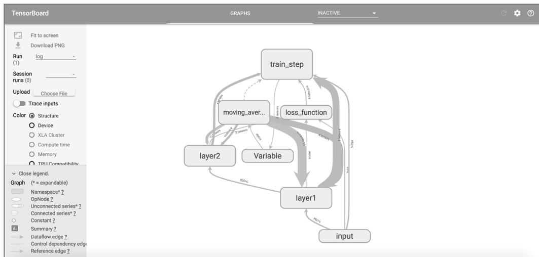
图 11-5 改进后的 MNIST 样例程序 TensorFlow 计算图可视化效果图
