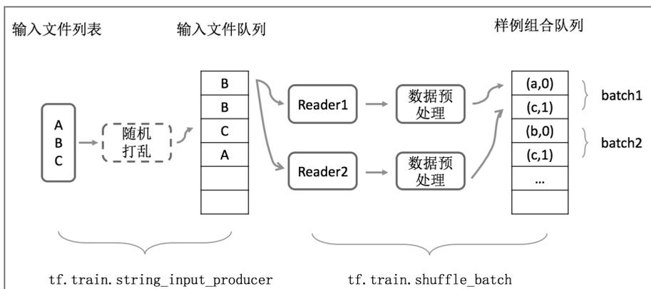
图 7-15 输入数据处理流程示意图
