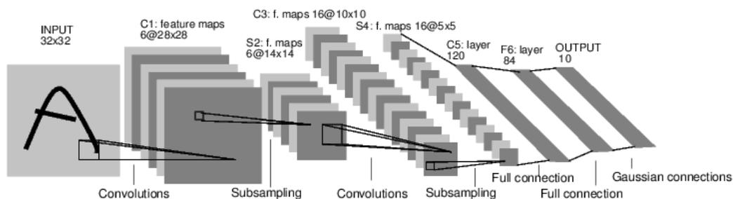
图 6-15 LeNet-5 模型结构图<sup>②</sup>
