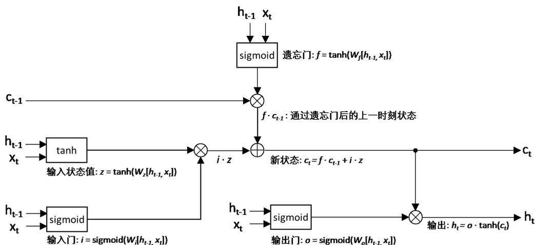
图 8-7 LSTM 单元细节图 (输入:  $C_{t-1}$ 、 $h_{t-1}$ 、 $X_t$ , 输出:  $C_t$ 、 $h_t$ )
