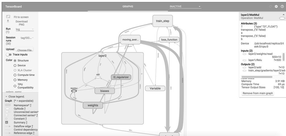
图 11-12 TensorFlow 计算节点在 TensorBoard 可视化效果图上的信息卡片
