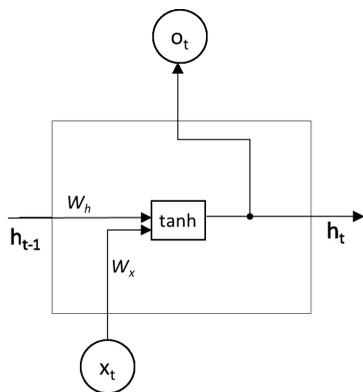
图 8-4 使用单层全连接神经网络作为循环体的循环神经网络结构图<sup>②</sup>
