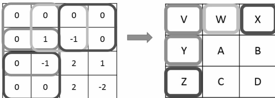
图 6-11 使用了全 0 填充 (zero-padding) 的卷积层前向传播示意图<sup>①</sup>
