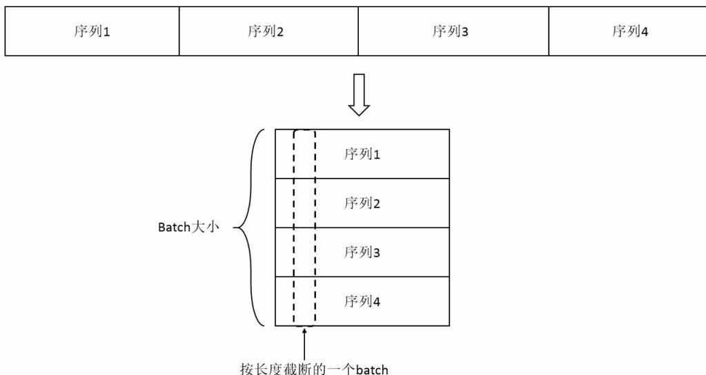
图 9-4 将一个长序列分成 batch 并截断的操作示意图
