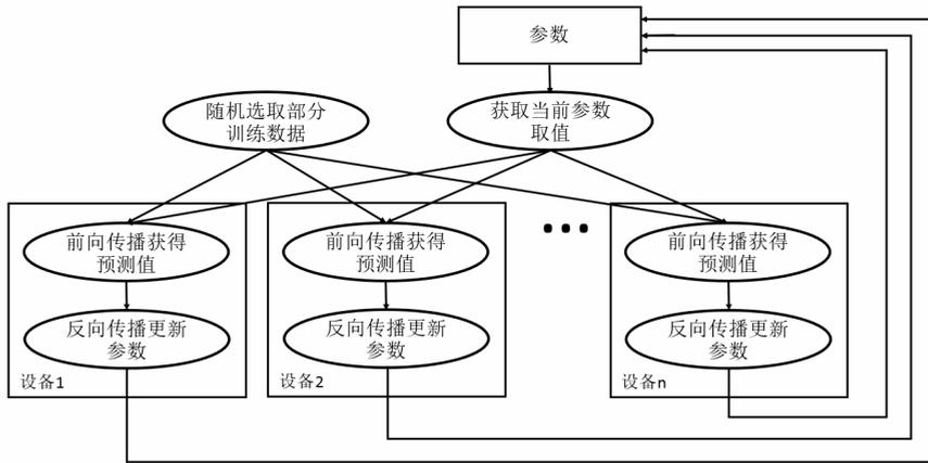
图 12-2 异步模式深度学习模型训练流程图
