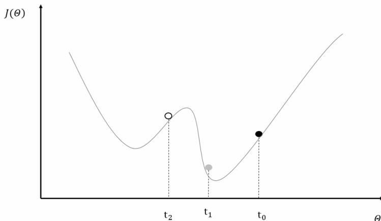
图 12-3 异步模式训练深度学习模型存在的问题示意图
