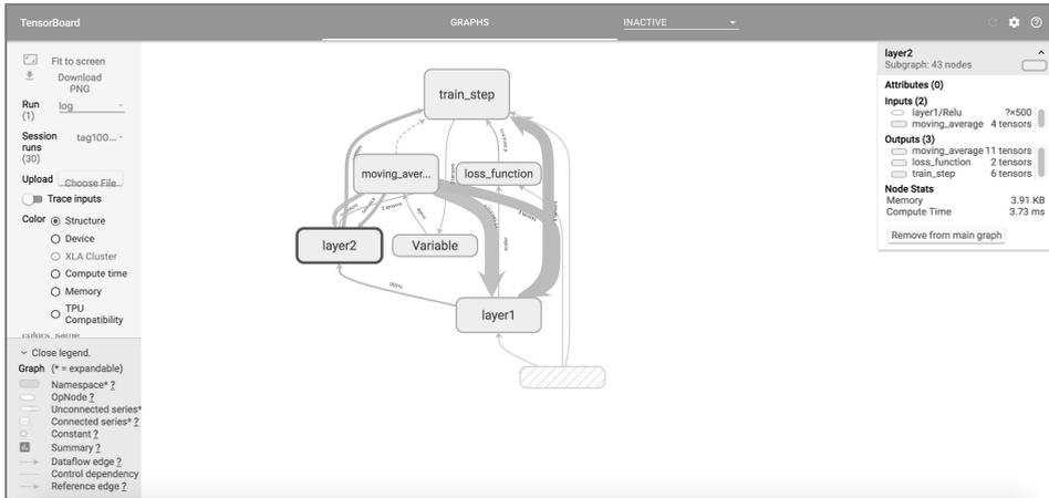
图 11-11 TensorFlow 命名空间在 TensorBoard 可视化效果图上的信息卡片
