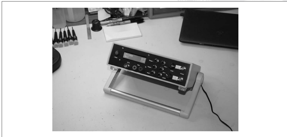
图 11-1：自制 DDS 信号发生器
