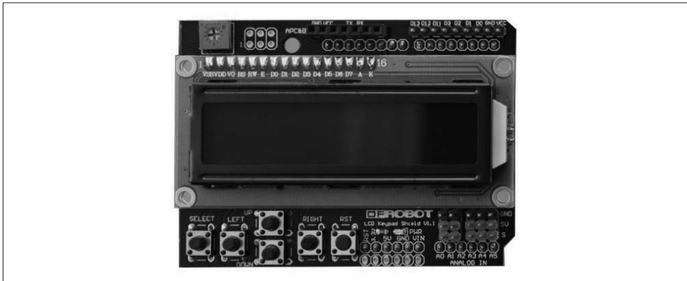
图 8-69: 带有模拟引脚的 DFRobot 16 × 2 LCD keypad 扩展板
