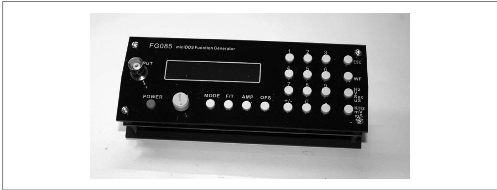
图 11-2: FG085 函数发生器套件 (已组装)
