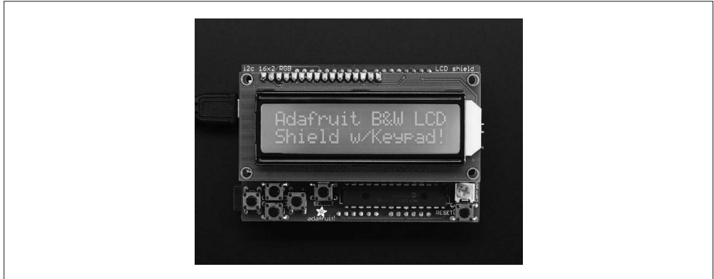
图 8-70: 带有 16 × 2 字符显示的 Adafruit LCD 扩展板套装
