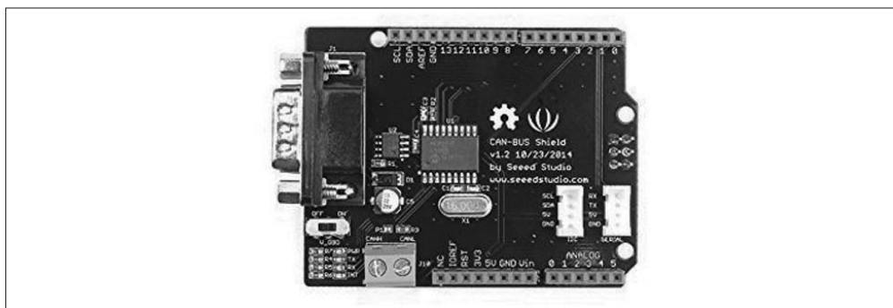
图 8-45: 带有辅助 I/O 连接器的 Seeed Studio CAN 扩展板
