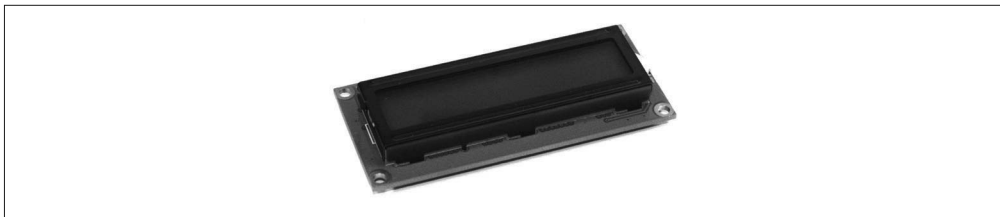
图 9-61: 采用 HD44780 或 ST7066 控制器的 16 \times 2 显示器
