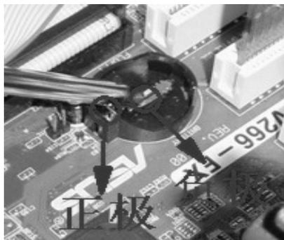
图 3-1-23 短接 CMOS 放电
