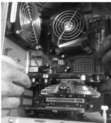
图 2-2-5 拆卸显卡
