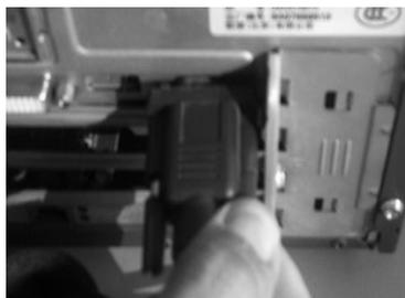
图 2-2-1 拆卸显示器接头
