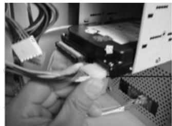
图 2-1-24 连接硬盘电源线
