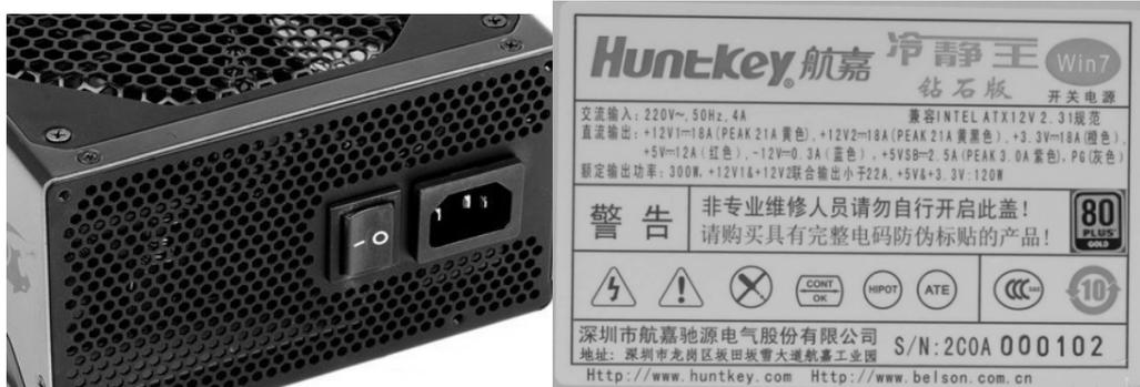
图 1-2-23 电源蜂巢形散热口和电源铭牌
