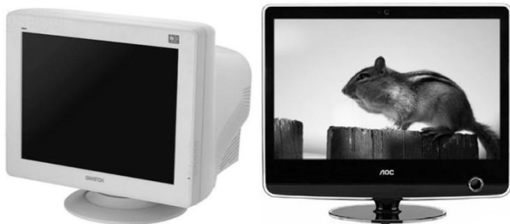
图 1-1-66 CRT 显示器和液晶显示器
