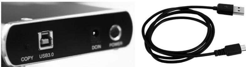
图 1-1-56 USB 接口移动硬盘与数据线
