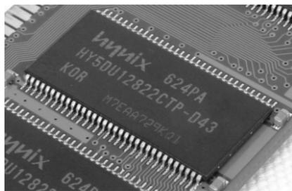
图 1-1-45 TSOP 封装
