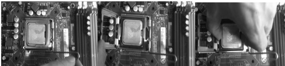
图 2-2-11 拆卸 CPU
