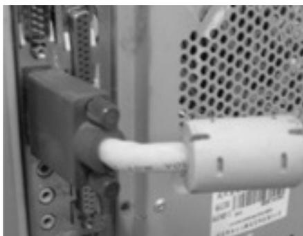
图 2-1-26 连接显示器
