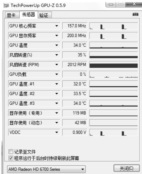
图 4-1-28 GPU-Z 传感器界面
