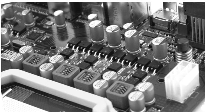
图 1-2-3 CPU 开关供电电路 (三相)
