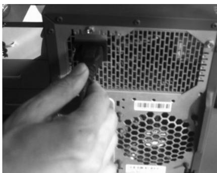
图 2-1-28 连接外部电源
