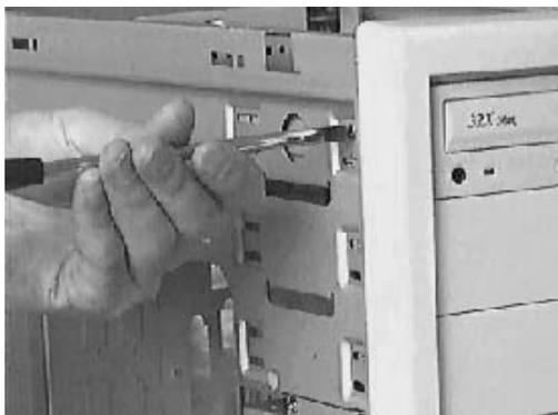
图 2-2-6 拆卸光驱
