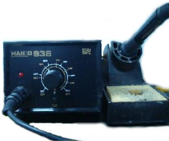
图 11-28 电烙铁温度调节
