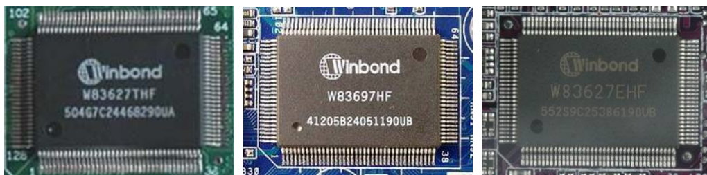
图 1-32 Winbond I/O 型芯片实物图
