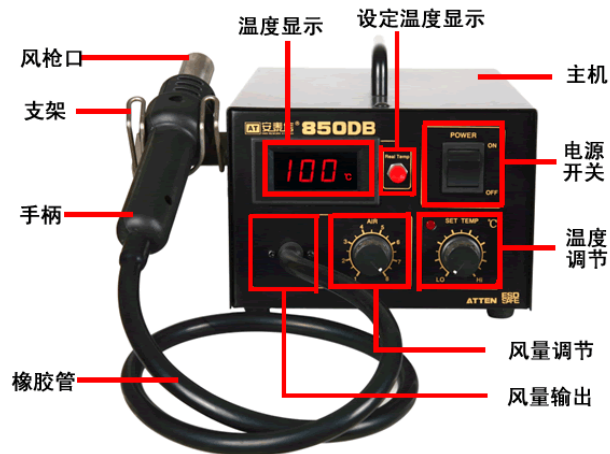
图 11-33 热风枪面板功能结构
