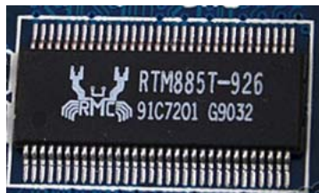
图 3-2 RTM885T—926 型时钟芯片
