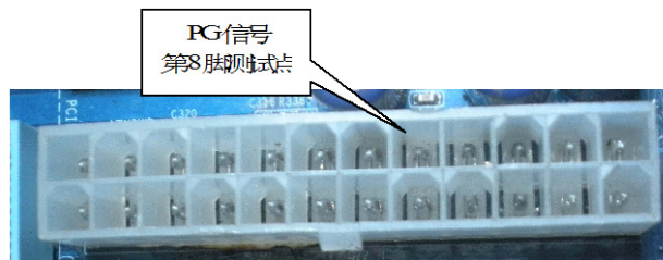
图 4-10 ATX 电源 PG 信号第 8 脚测试点
