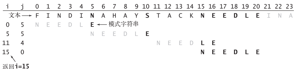
图 5.3.10 从右向左的 (Boyer-Moore) 子字符串查找中的启发式地处理不匹配的字符
