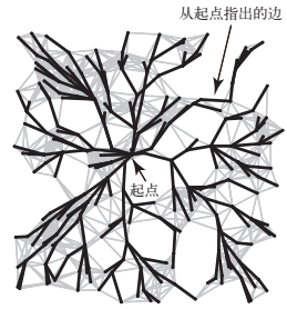
图 4.4.3 一棵含有 250 个顶点的最短路径树
