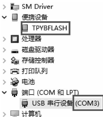
图 6.13 查看 TPYBoard V102 开发板的端口号
