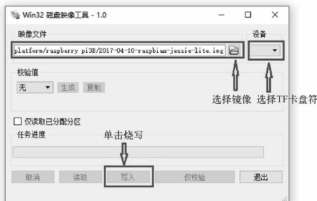
图 7.9 带操作系统 TF 卡的制作
