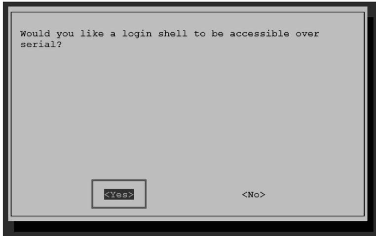
图 7.14 确认打开串口终端
